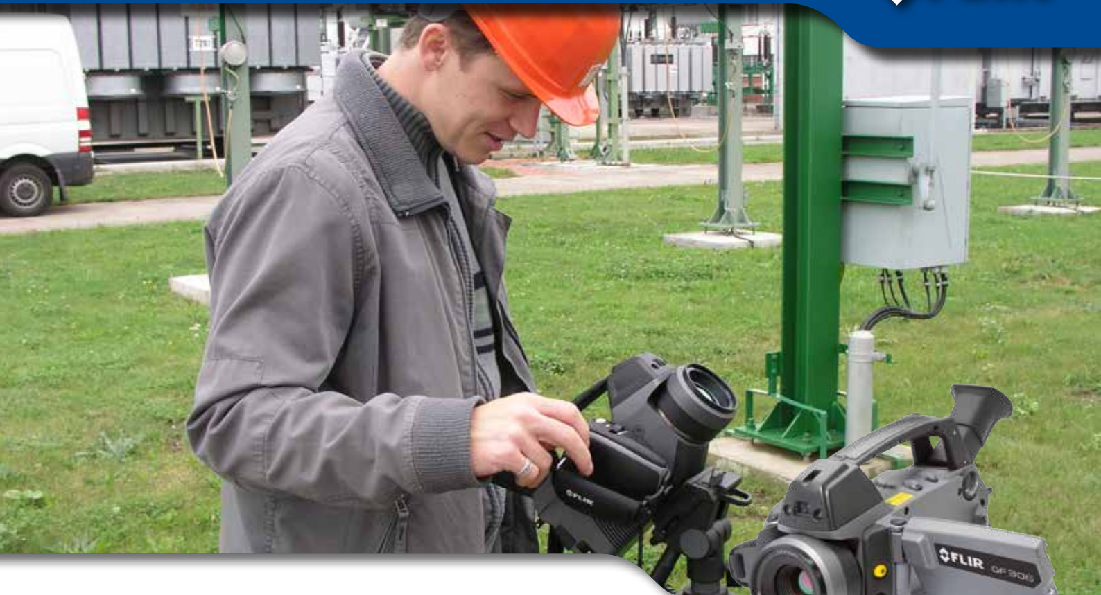
FLIR GF306光学气体红外热像仪能够对气体泄漏实时可视化。
