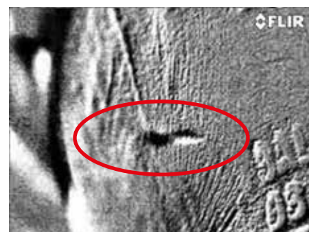
FLIR GF306光学气体红外热像仪可从安全距离轻松检测含有SF 6 气体的绝缘体。
