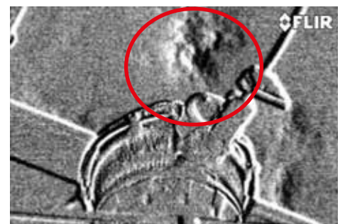
使用FLIR GF306光学气体红外热像仪，气体泄漏清晰可见。
